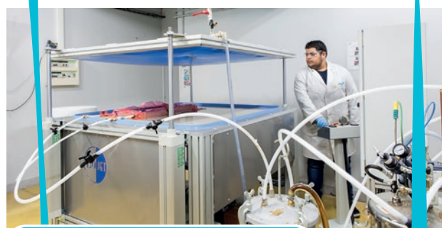
Mise en œuvre de composites par le procédé d'infusion sous vide (presse Isojet)
