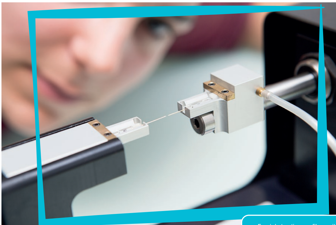
Essai de traction sur fibre unitaire
