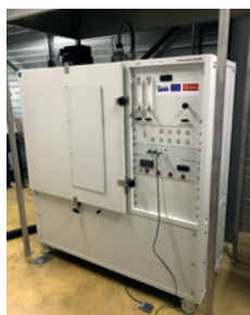
Mise en œuvre des biocomposites par extrusion double vis à l'échelle laboratoire (0,5 kg/h)
