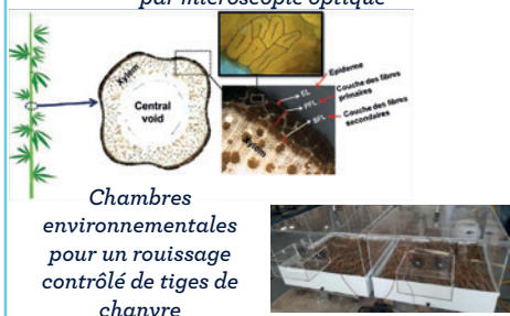
Microstructure d'une tige de chanvre par microscopie optique
