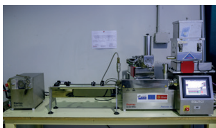
Mise en œuvre des biocomposites par extrusion double vis à l'échelle laboratoire (0,5 kg/h)
