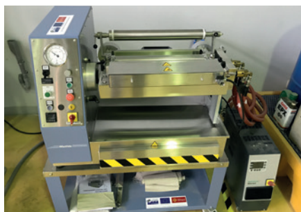
Traitement de surface de tissus de fibres végétales par foulardage
