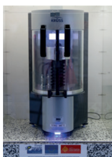
Mesure des propriétés de surface des fibres végétales par tensiométrie
